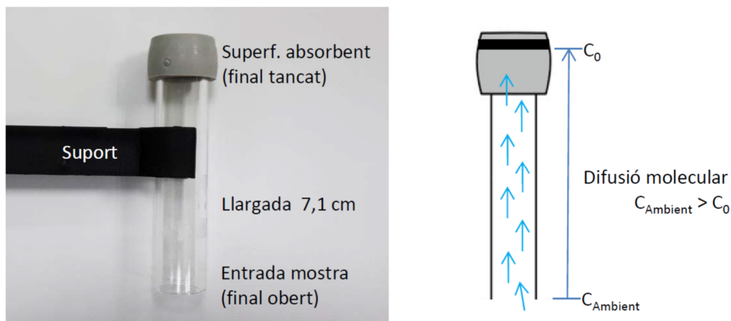
Figura 1: Principi de funcionament dels tubs passius de difusió de \text{NO}_2 de tipus Palmes, on C_{\text{Ambient}} és la concentració de la mostra ambiental i C_0 és la concentració a la superfície de l'absorbent.
